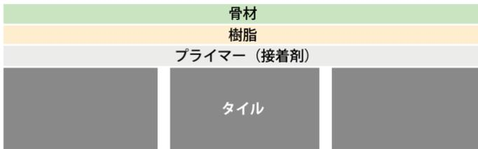
※樹脂と骨材により、表面にざらつきを持たせます
